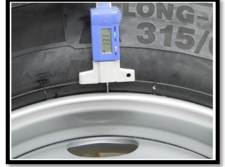
Şekil 1: Damağın tüm çevre boyunca jantta doğru oturup oturmadığını kontrol edilir.
