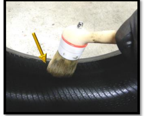
Şekil 2: Lastik damağının jantta doğru oturmasını sağlamak ve titreşimi önlemek için jant flansına, lastiğin iç ve dış damağına montaj kremi uygulanır.
