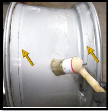
Şekil 2: Lastik damağının jantta doğru oturmasını sağlamak ve titreşimi önlemek için jant flansına, lastiğin iç ve dış damağına montaj kremi uygulanır.
