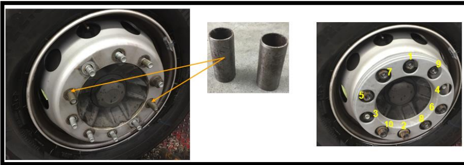
Şekil 3: Jant saplama delikleri saplamalardan daha büyükse, tekerleği ortalamak için rondela (yüzük) kullanın.
