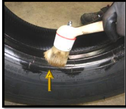
Şekil 2: Lastik damağının jantta doğru oturmasını sağlamak ve titreşimi önlemek için jant flansına, lastiğin iç ve dış damağına montaj kremi uygulanır.
